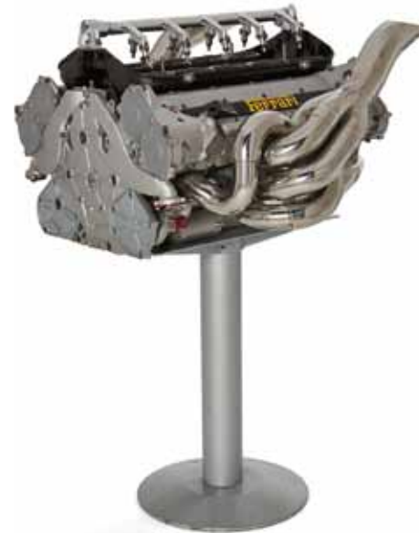
• 122 • FERRARI Rare moteur – Type 049 – Saison 2000 #049-112057, monté sur un socle de présentation, caractéristique du moteur type 049 : 10 cylindres en V à 90°, 40 soupapes, double arbre à cames en tête, 2997 cm 3 , 815 ch à 17000 tr/mn. Il équipait la F1-2000 de la Scuderia qui devint championne du Monde cette année-là. Vendu avec sa flight caisse sur mesure, son socle de présentation et un certificat d'authenticité daté 9.1.2006 Haut. du moteur : 49 cm. (19 ¼ in.). Avec socle : Haut : 116 cm. (41 ¾ in.), Long. : 73 cm. (28 ¾ in.), Prof. : 90 cm. (35 ½ in.) Rare type 049 engine, for F1-2000, mounted on a pedestal. It used to equipped the F1-2000 during season 2000 when the Scuderia became world Champion. Sold with its flight case, its pedestal and a certificate of origin 60 000 – 80 000 €
