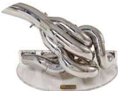
• 123 • FERRARI Collecteur d'échappement droit F1-2000 – saison 2000 En inconel chromé, provenant d'un moteur type 049 de la saison 2000, monté sur un socle en plexiglas Avec socle : Haut. : 36 cm. (14 ¼ in.), Long. : 55 cm. (21 ¾ in.) F1-2000 chromed plated exhaust, mounted on a plexiglass base 3 000 – 4 000 €
